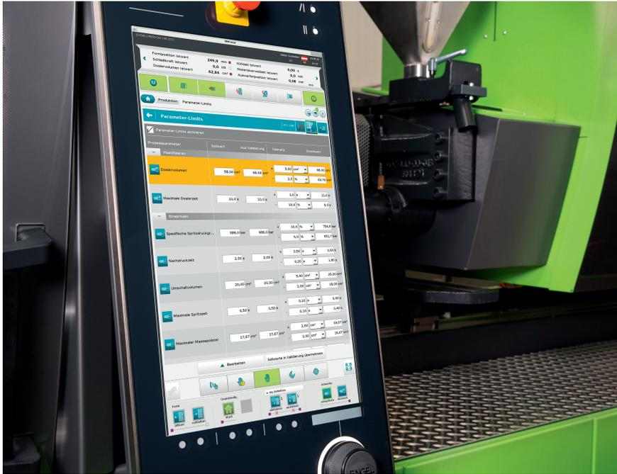
**Bild 3.** Die ausgewählten Prozessparameter werden auf einer eigenen Seite in der CC300-Steuerung übersichtlich dargestellt. © Engel
